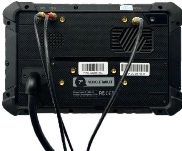
Figura 3 - Connettori antenne
